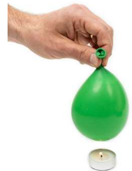
Wassergefüllter Luftballon über einer Kerze
