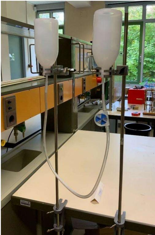
In vielen Sammlungen findet sich auch dieser Versuch, als Modell für die Spannung. Man kann ihn aber auch verwenden, um zu zeigen, dass ein größerer Höhenunterschied zu einem schnelleren Drehen des Wasserrads führt und damit hier wirklich Höhenenergie in kinetische Energie umgewandelt wird.
