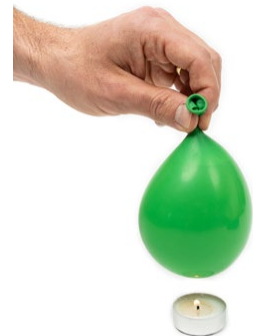
Wassergefüllter Luftballon über einer Kerze
