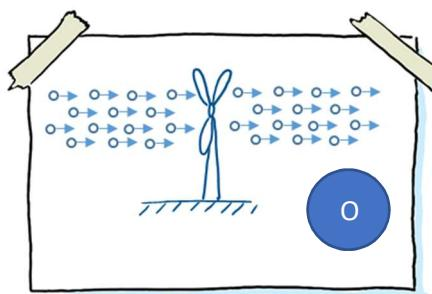
Schon 1919 bewies der deutsche Physiker Albert Betz, dass nur maximal 59% der Windenergie in elektrische Energie umgewandelt werden können. Je mehr Bewegungsenergie man dem Wind entnimmt, um so langsamer wird die Luft hinter dem Windrad. Irgendwann ist die Luft so langsam, dass sie die durch die Rotorblätter strömende Luft behindert.
