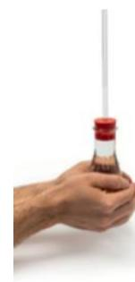
2. Verschließe ihn mit Gummistopfen und Glasrohr. Achte darauf, dass das Wasser im Rohr steht und sich keine Luftblasen bilden.
